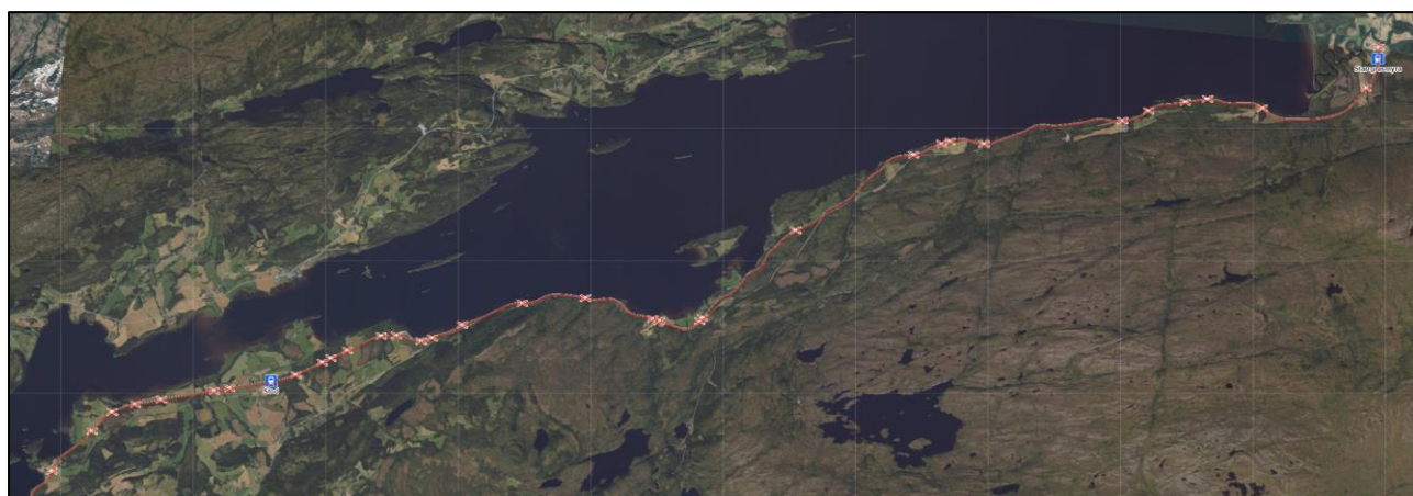
Figur 3 Planoverganger som er registrert i Bane NORs kart er vist med røde kryss. Strekningen der det søkes om å bygge vilt-/sikringsgjerde er vist med rød linje/farge. Kilde: banekart.banenor.no/kart
